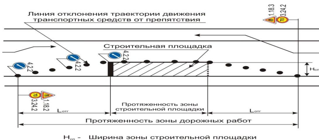
Рисунок А.1 - Зоны дорожных работ и строительной площадки
