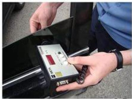
Для проведения проверки необходимо совместить корпуса осветителя и фотоприемника по нанесенным меткам и включить прибор. После 10-секундного прогрева подается короткий звуковой сигнал и выполняется калибровка (устанавливается значение 100+/-0,2%).
