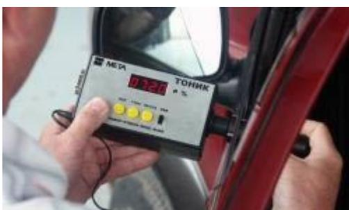
Измеритель светопропускания тонированных и затемненных стекол «ТОНИК» предназначен для определения светопропускания стекол тонированных и затемнённых различного назначения, в том числе и установленных на автотранспортных средствах.
