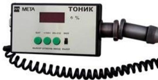
Проверка осуществляется специальными приборами с абсолютной погрешностью не более 2 %. Кроме того, в них должна быть предусмотрена компенсация внешней засветки, не связанная с толщиной стекла. Светопропускание измеряется в трех разных точках каждого
