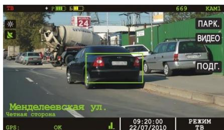
время патрулирования. Видеофиксатор ПАРКОН оснащён двумя видеокамерами не случайно: одна из них - широкоугольная - фиксирует дорожные знаки и разметку, а вторая - длиннофокусная - предназначена для записи автомобильных номеров. Прожектор же позволяет осуществлять эффективное патрулирование даже в темное время суток или в условиях ухудшенной видимости.
