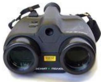
Узконаправленное лазерное излучение, которое позволяет выделить в плотном потоке любое ТС. Наличие на экране монитора метки, указывающей на границы лазерного излучения, что позволяет однозначно идентифицировать ТС, нарушившее скоростной режим.
