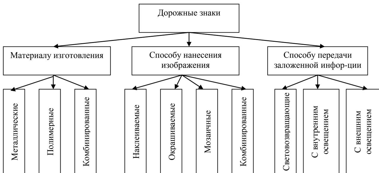
Рисунок 2. Классификация дорожных знаков в зависимости от способа изготовления и материала
