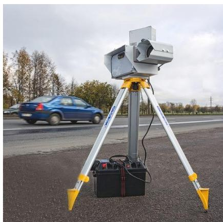
Подготовка к работе занимает не более 10 минут. Арена устанавливается на треноге, на обочине дороге, в 3-5 м от края контролируемой проезжей части. Питание прибора производится от аккумулятора, размещенного в специальном боксе. Все превысившие установленный порог скорости транспортные средства автоматически фотографируются. Данные нарушениях накапливаются в памяти
